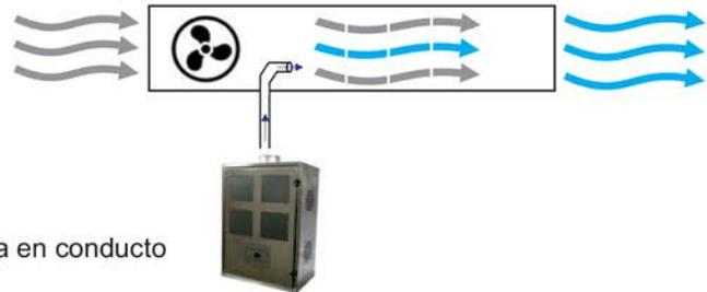
Sistema de inyección directa en conducto
